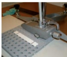
Les résultats du test correspondent à des moyennes de plusieurs cycles de tests utilisant deux différents types de clichés de caoutchouc. Le caractère anti-dérapant est ainsi mesuré sur surfaces sèches et humides.
