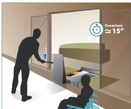
Une personne vient déplier la rampe s'il s'agit d'une rampe manuelle. La rampe peut aussi se déplier seule si elle est automatique.
